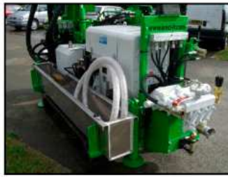
Rack à tiges / pipe rack
